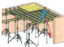
K zabránění pádu z výšky při zhotovování bednění a odbedňování zajištěna ochrana proti pádu přednostně pomocí prostředků kolektivní ochrany
